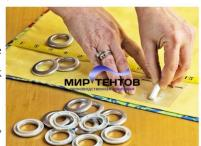
будущей установки. Стандартное расстояние между двумя металлическими кольцами для самых разных тентовых изделий - 0,5 метра. Отметки ставят с учетом диаметра колец (он может быть различным - от 10 до 20 мм и даже более). Точно и четко нанесенная разметка в разы упростит дальнейшую работу и позволит ее выполнить с максимальной скоростью.
